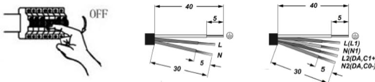
3. Підключити мережеві дроти до колодки на задній стінці корпусу відповідно до зазначененої полярності. При використанні регульованого драйвера, керуючі дроти підключаються строго з дотриманням полярності, зазначененої в маркуванні.
