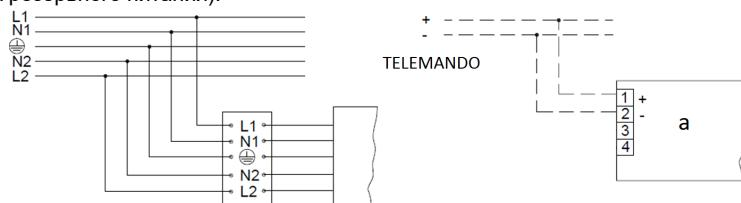
3. Схема подключения светильника к питающей сети с регулируемым драйвером по системе DALI.
